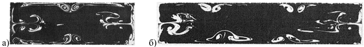
Рисунок 1.3.2. Вторичные течения внутри прямоугольного сопла для двух различных значений AR , а) Re=6\,400-13\,000 , AR=3 , б) Re=5\,400-7\,400 , AR=4 [34].
